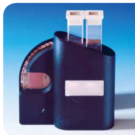
Parte posterior del Comparator CHECKIT® con disco, placa difusora y cubetas
