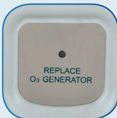
Indicador para cambio de generador
